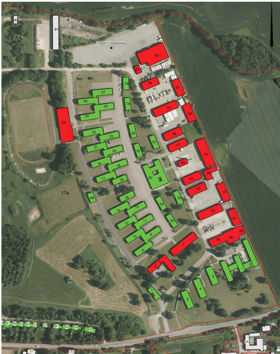
Figur 5: Luftfoto med kategorisering af fremtidige anvendelser af bygninger. Bygninger markeret med grønt kan anvendes til beboelse uden yderligere undersøgelser eller bygningstiltag. Bygninger markeret med rødt kan ikke anvendes til beboelse uden yderligere undersøgelser eller bygningstiltag (se Bilag 6).
